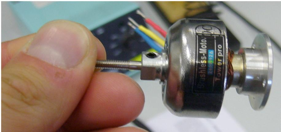
Abb. 10 Brushless-Motor (Aussenläufer)
