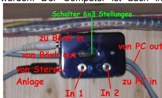
Stellung 1: St.A. (Stereoanlage) mit Böxli out, PC out mit Böxli in, PC in mit In 2
